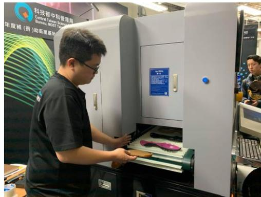
3D空氣極光設備取代打粗工序和膠水
